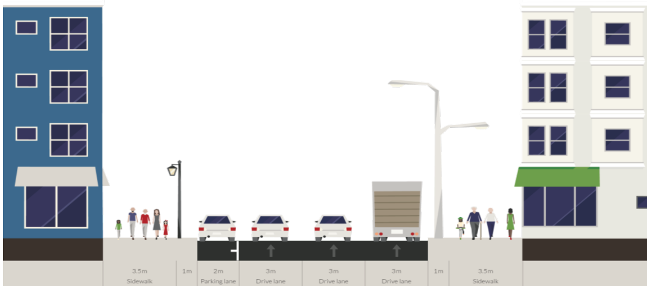
Figura 12: Perfil viário padrão da Via Coletora 1 – Sentido Único (TIPO 3)
