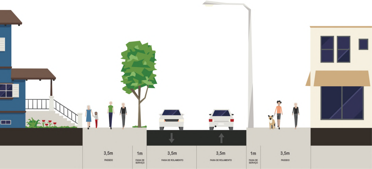
Figura 40: Perfil viário padrão da Via Local - Sentido Duplo (TIPO 40)
